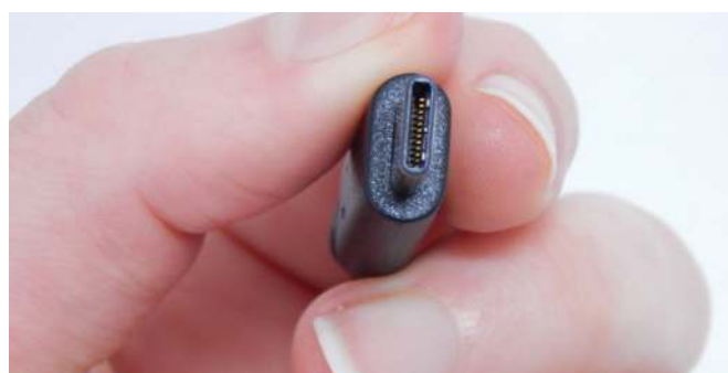
USB Typ C Stecker kann in beide Richtungen eingesteckt werden.
